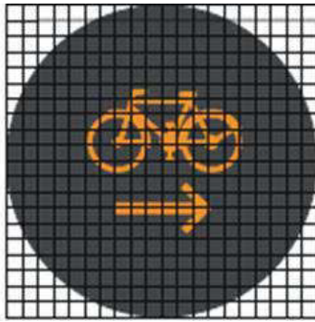
c) Bijkomend oranjeel knipperlicht met fietssilhouet en oranjegele knipperende pijl
