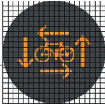
c) Bijkomend oranjeel knipperlicht met fietssilhouet en oranjegele knipperende pijl
