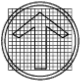
Plaat 2. Driekleurige verkeerslichten: stelsel met pijlen
