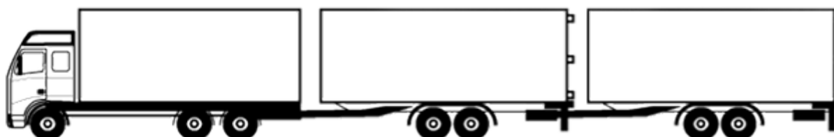
Vrachtwagen + middenas-aanhangwagen + middenas-aanhangwagen
